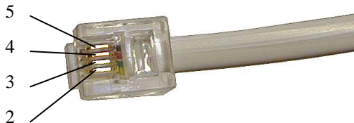
Нумерация контактов вилки 6Р4С (контакты 1 и 6 отсутствуют)
